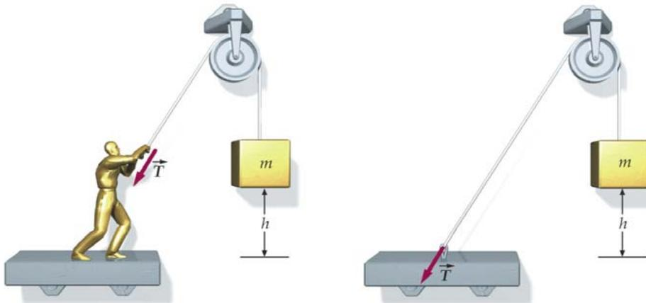
Das Halten eines schweren Körpers in einer festen Stellung erfordert das Aufbringen von Energie, aber laut Definition wird keine Arbeit verrichtet.
