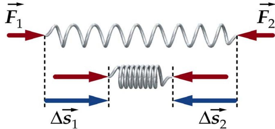
Erhöhung der potentiellen Energie beim Zusammendrücken der Feder
