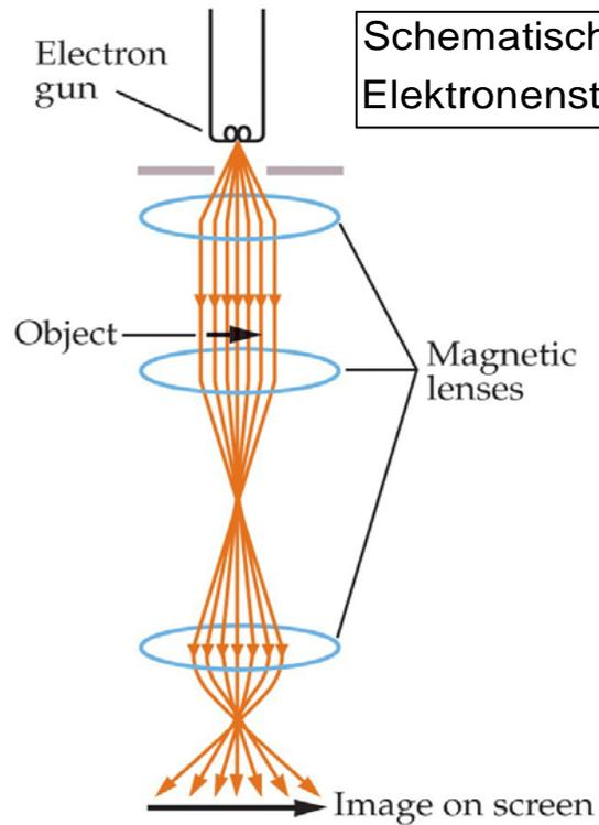
Schematischer Aufbau eines Elektronenmikroskops:
