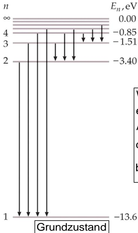
Wasserstoffatom: ein Elektron ist durch die elektrostatische Anziehungskraft an ein Proton gebunden  $\Rightarrow$  die potentielle Energie ist umgekehrt proportional zum Abstand  $\Leftrightarrow$  für  $r = \infty$  ist  $E_{\text{pot}} = 0$  gesetzt  $\Rightarrow$  für  $r < \infty$  ist  $E_{\text{pot}} < 0$   $\Rightarrow$  die Energien  $E_n$  des Elektrons im Wasserstoffatom durch eine Quantenzahl  $n$  beschrieben werden:  $E_n = -\frac{13.6 \text{ eV}}{n^2}$  wobei  $n = 1, 2, 3, \dots$
