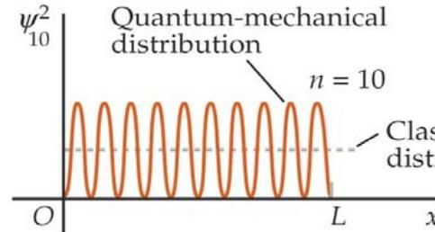
Aufenthaltswahrscheinlichkeitsdichte  $\psi^2$  in Abhängigkeit von  $x$  für ein Teilchen im Kasten der Länge  $L$
