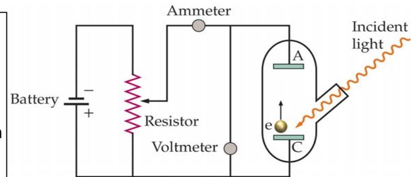
Ergebnis des Experimentes: die maximale Energie der emittierten Elektronen bei derselben Wellenlänge des einfallenden Lichts ist stets gleich, unabhängig von der Intensität des auf die Kathode eintreffenden Lichts  $\Rightarrow$
