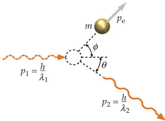
Die Streuung elektromagnetischer Strahlung durch ein Elektron kann als Stoß eines Photons mit Impuls  $p_1 = h/\lambda_1$  auf ein ruhendes Elektron angesehen werden  $\Rightarrow$  das gestreute Photon hat wegen des Rückstoßes des Elektrons eine geringere Energie und damit eine größere Wellenlänge  $\lambda_2$  als das einfallende Elektron:
