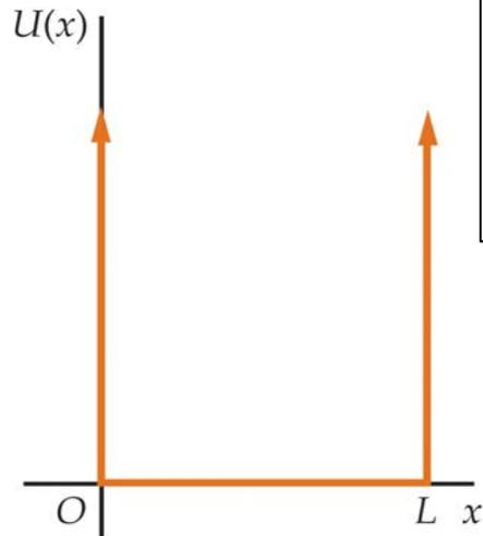
Potentialverlauf bei einem Kasten mit unendlich hohen Wänden:
