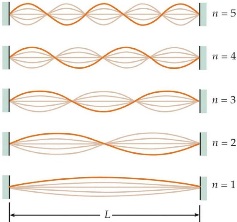
Die Bedingung für stehende Wellen auf einer Saite, die an beiden Enden fixiert ist, ist die gleiche wie die für stehende Wellen beim Teilchen im Kasten.
