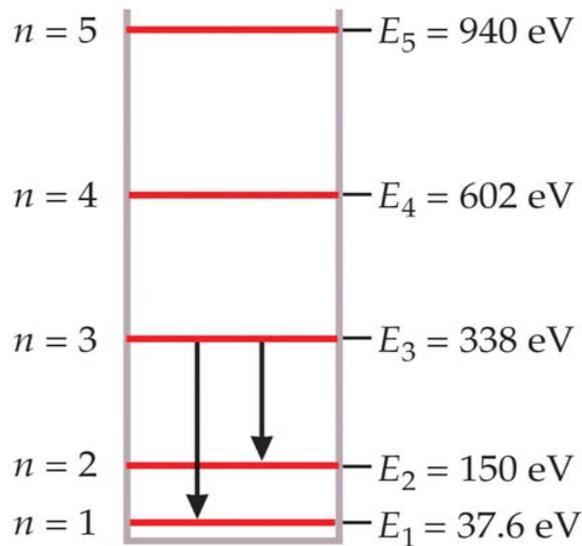
Elektron in eindimensionalem Kasten mit  $L = 0.1 \text{ nm}$   $\Rightarrow$  Gesucht: a) Energie  $E_1$  des Grundzustands, b) Energie  $E_2$  bis  $E_4$ , c) Energie des emittierten Photons ausgehend von Zustand mit  $n = 3$   $\Rightarrow$
