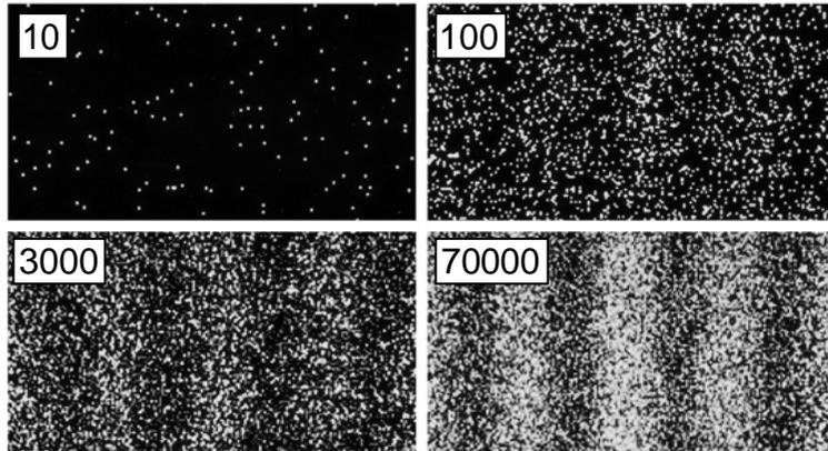
Interferenzmuster durch Elektronen, die einen Doppelstalt passieren
