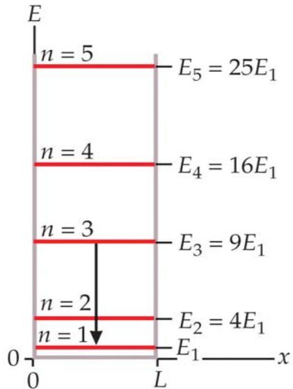
Die Bedingung  $\psi = 0$  bei  $x = 0$  und  $x = L$  ist eine sogenannte Randbedingung  $\Leftrightarrow$  Randbedingungen führen in der Quantenmechanik zur Quantisierung von Energie  $\Rightarrow$  Ist ein Teilchen räumlich auf einem bestimmten Bereich beschränkt, dann besitzt es eine minimale kinetische Energie = Nullpunktsenergie.
