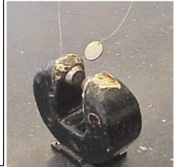
Eine Nickel-Münze wird von einem Magneten angezogen
