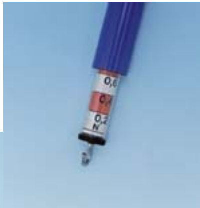
Präzisionskraftmesser nach Prof. Maey (Dynamometer), 0,1 N
